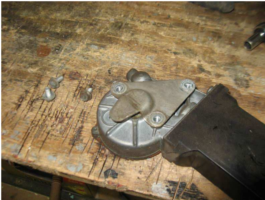
Original Motor E9 mit Abdeckkappe
